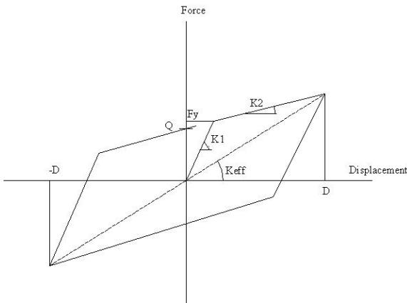
شکل (۲): مدل دوخطی و تعریف پارامترهای جداگرهای
