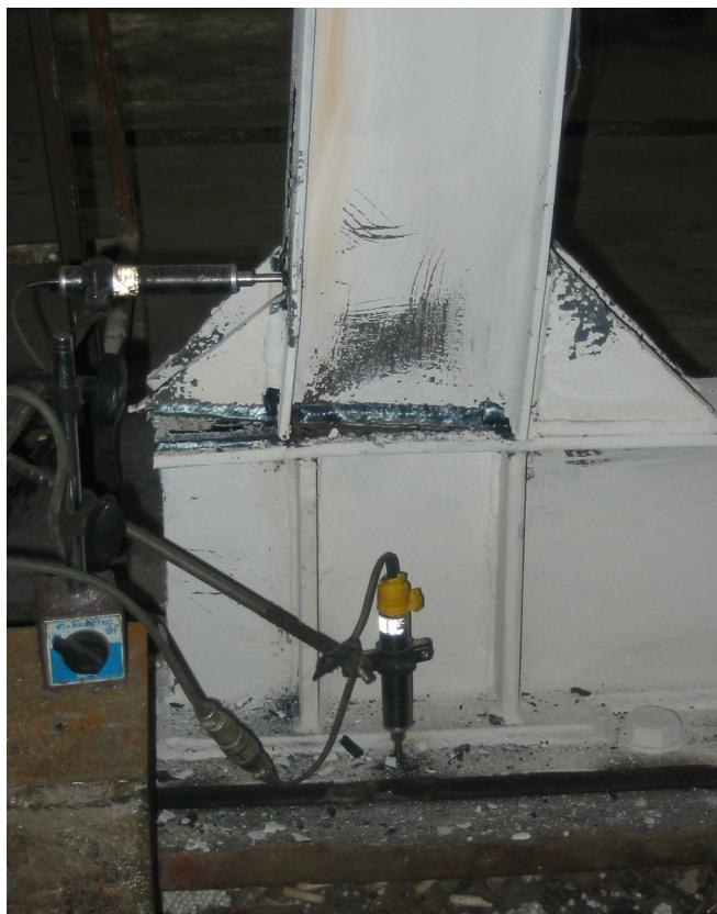
شکل (۶) : شکست اتصال ستون قاب پیرامونی به تیر تراز صفر - صفر در انتهای آزمایش
