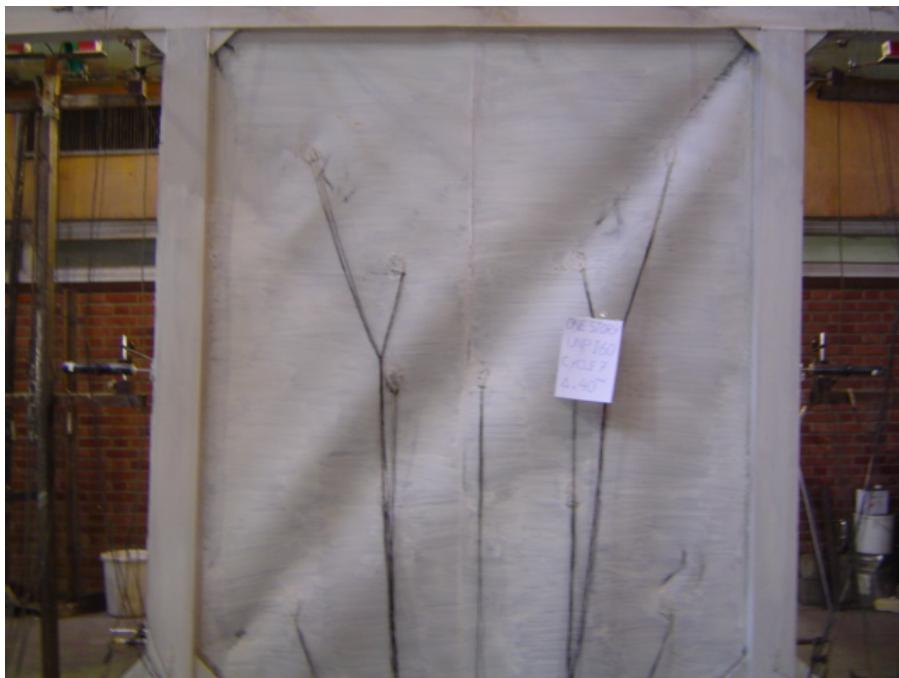
شکل (۳) : کمانش ورق در سیکل هجدهم
