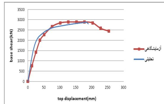
شکل (۵): مقایسه منحنی بار- تغییر مکان مدل آزمایشگاهی و مدل تحلیلی آستانه در نمونه بدون درز.
