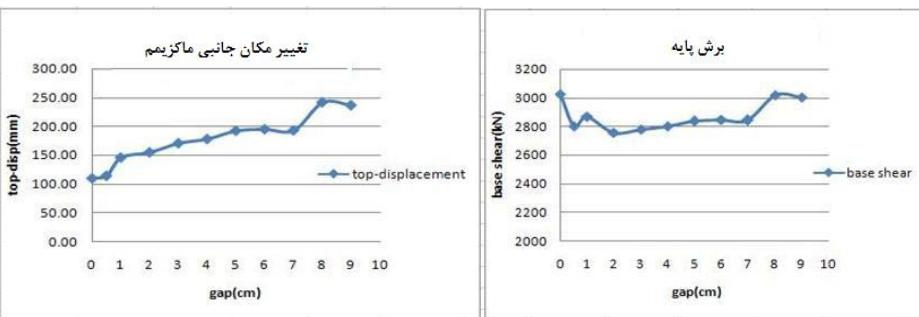
شکل (۱۳): تاثیر درز بین پانل بتنی و قاب بر تغییر مکان جانبی و برش پایه در مدل با دهانه 6m - ۳ طبقه
