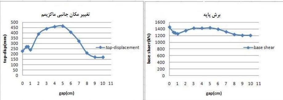
شکل (۱۴): تاثیر درز بین پانل بتنی و قاب بر تغییر مکان جانبی و برش پایه در مدل با دهانه 3m - ۳ طبقه
