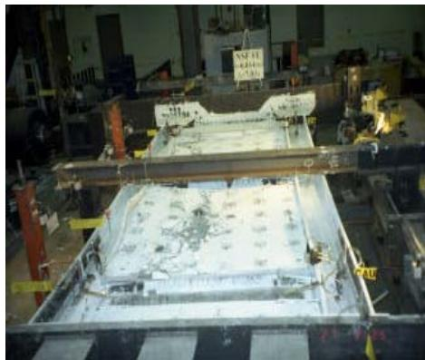
شکل (۱): نمونه آزمایشگاهی دیوار برشی مرکب با درز آستانه اصل.
