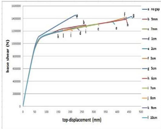
شکل (۱۰): منحنی بار- تغییر مکان نمونه با دهانه ۳ - ۵m طبقه با درزهای مختلف
