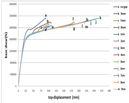
شکل (۹): منحنی بار- تغییر مکان نمونه با دهانه ۳ - ۴/۵m طبقه با درزهای مختلف
