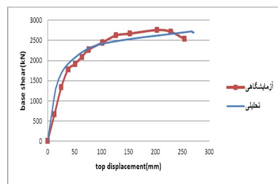
شکل (۶): مقایسه منحنی بار- تغییر مکان مدل آزمایشگاهی و مدل تحلیلی آستانه در نمونه با درز.
