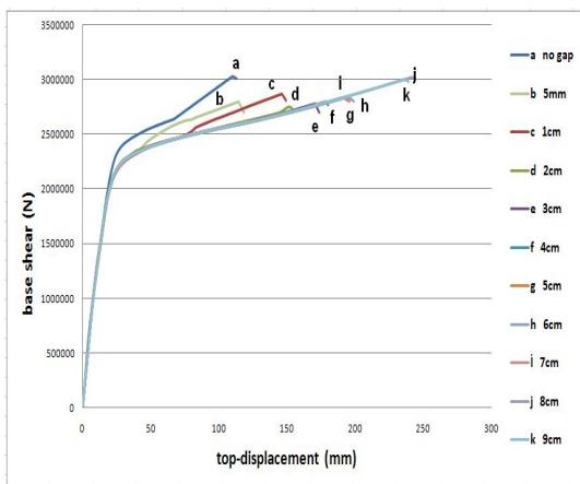
شکل (۹): منحنی بار- تغییر مکان نمونه با دهانه ۳ - ۶m طبقه با درزهای مختلف
