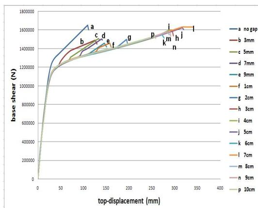
شکل (۷): منحنی بار- تغییر مکان نمونه با دهانه ۳ - ۳m - ۳ طبقه با درزهای مختلف
