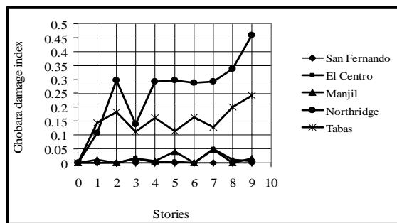
شکل (۱۶): مقدار خرابی طبقه‌ها با استفاده از شاخص قبارا بعد از بهسازی با مهاربند و اگرا
