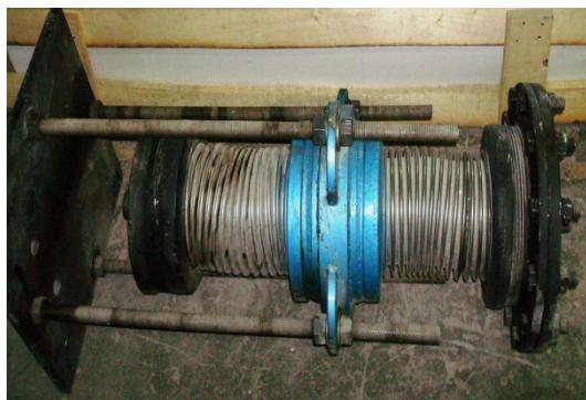
شکل(۴): نمونه اولیه ساخته شده میراگر ویسکوز [۵]
