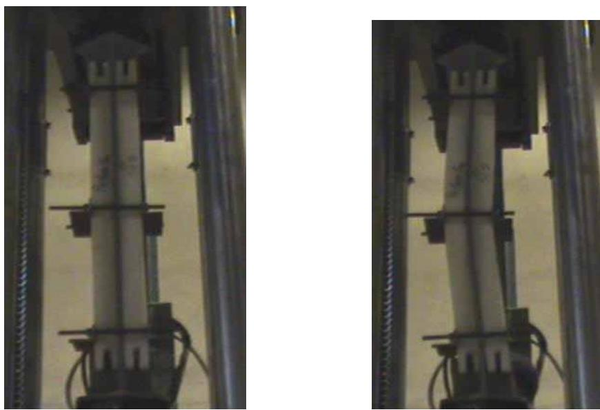
شکل (۷): بادبند با پوسته پلی اتیلنی با محور ضعیف، قبل و بعد از کمانش (نمونه S1)
