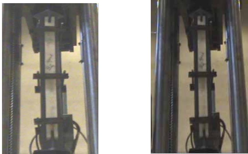
شکل (۶): بادبند با پوسته پلی اتیلنی با محور قوی ، قبل و بعد از کمانش (نمونه S2)
