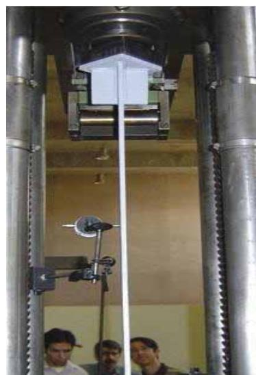
شکل (۵): نمونه A1، بادبند یا هسته تحت آزمایش فشار محوری (قبل و بعداز کمانش)
